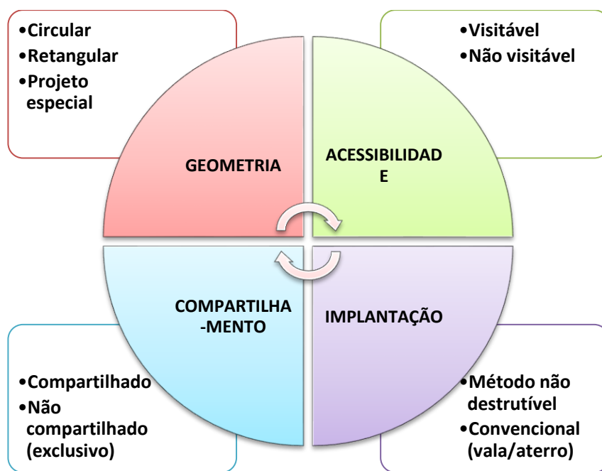
Figura 7 - Infraestrutura existente Classificação das galerias Técnicas
